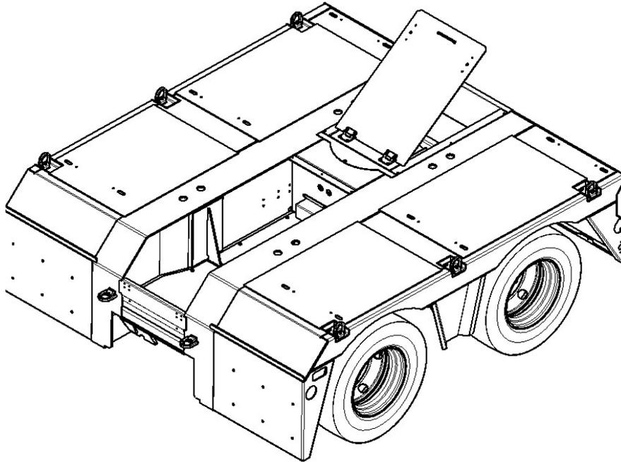
Heckteil 24 to. mit hydraulischer Federung und Lenkung
